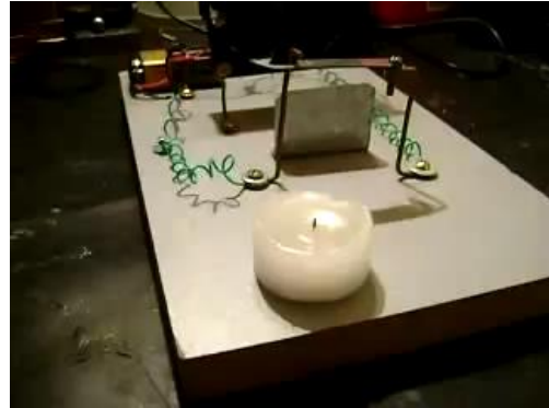
Alarme de incêndio
